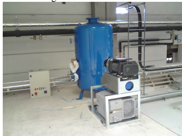
Billedet viser et eksempel på et "mindre" anlæg til centralisering af 3 Multivac pakke maskiner som pakker 1700 liter pandekager i timen.
